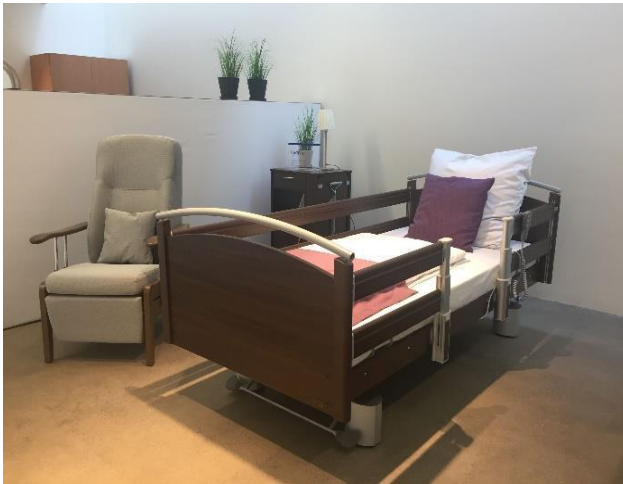
Pflegebett 90 x 200 cm, sichere Arbeitslast 200 kg, max. Personengewicht 165 kg, Höhenverstellung : 29-73 cm
